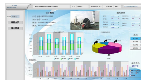
建筑能耗节能管理安全系统总监控界面
