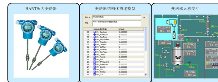
图3 基于工程对象模型的 HART 设备信息诊断
